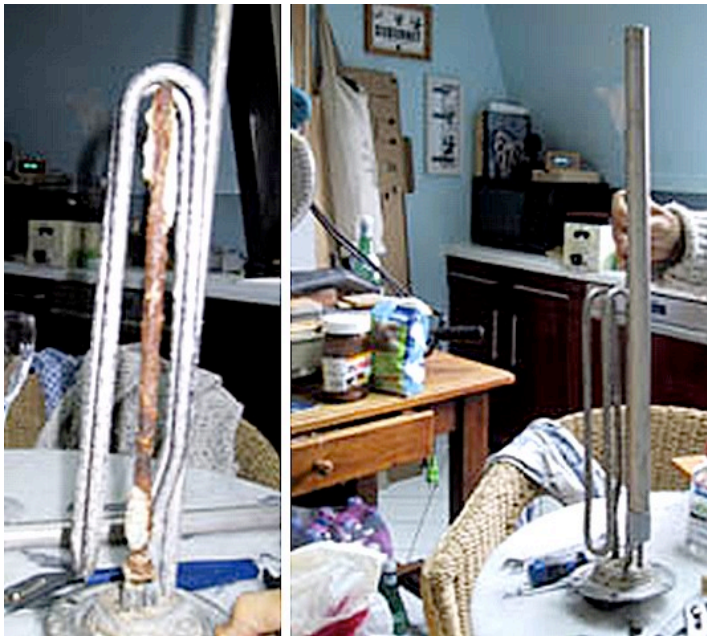
Résistance chauffante et anode auxiliaire d'un chauffe eau domestique
